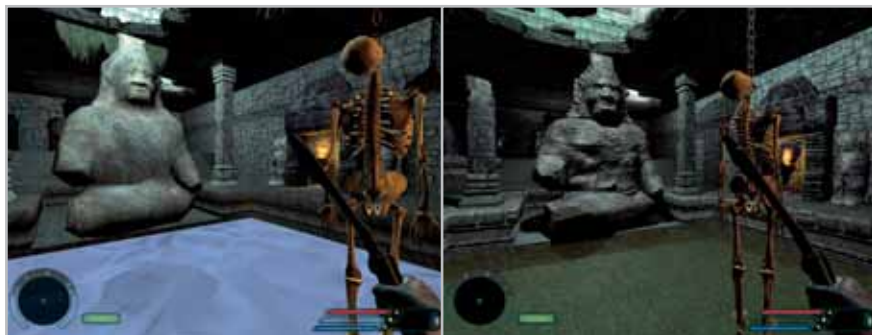
Zastosowanie programów shaderowych do generowania grafiki 3D przynosi znaczną poprawę jakości wyświetlanej grafiki. Po lewej scena 3D (gra FarCry) z wyłączoną jednostką Pixel Shader, po prawej zaś to samo ujęcie po włączeniu jednostki Pixel Shader 3.0 (nVidia GeForce 6800).
