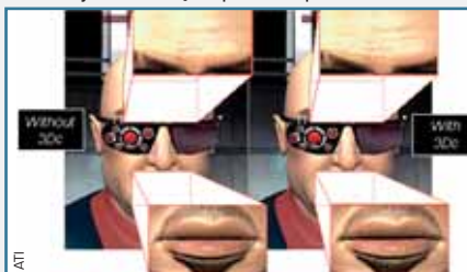
Opracowana przez firmę ATI metoda kompresji tekstur 3Dc ma według producenta kilkakrotnie poprawić jakość spakowanych stratnym algorytmem tekstur.
